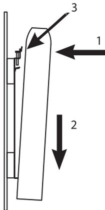
❶ et ❷ Placer et fixer l'appareil en partie haute sur les pattes prévues à cet effet. Appuyez vers le bas pour enclencher.
